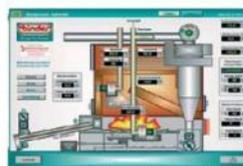
La visualisation consiste à échanger les paramètres de l'installation avec un ordinateur. Des illustrations concrétisent les différentes connexités. De plus il est possible d'historiser les données sur une période prolongée. Un accès à distance par modem est possible
