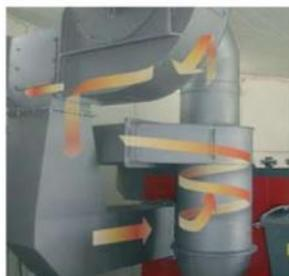
Pour le nettoyage des tubes de fumée, une partie des gaz de combustion sont renvoyés à haute vitesse à travers l'échangeur, entraînant les particules déposées qui sont ensuite éliminées au niveau du cyclone
