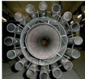
Jusqu'à 150 kW les chaudières sont équipées avec des tubes de fumée verticaux. Des turbulateurs flexibles assurent le nettoyage des tubes et un échange optimal de la chaleur
