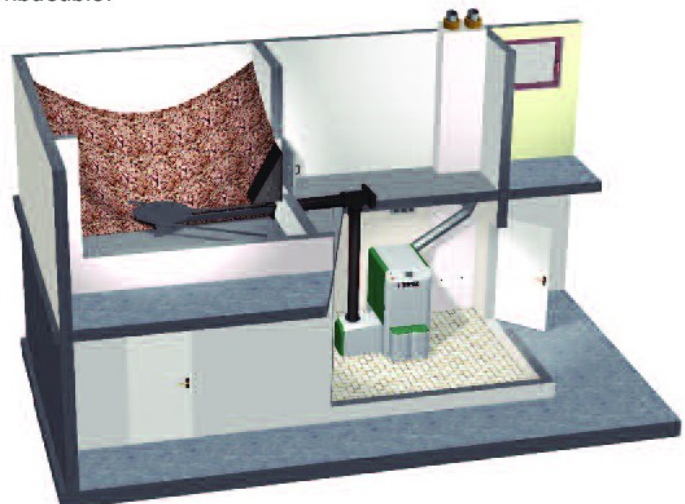
Silo de stockage et chaufferie sur des niveaux différents. Extraction de silo par plateau dessileur rotatif posé à plat et tube de chute par gravité.
